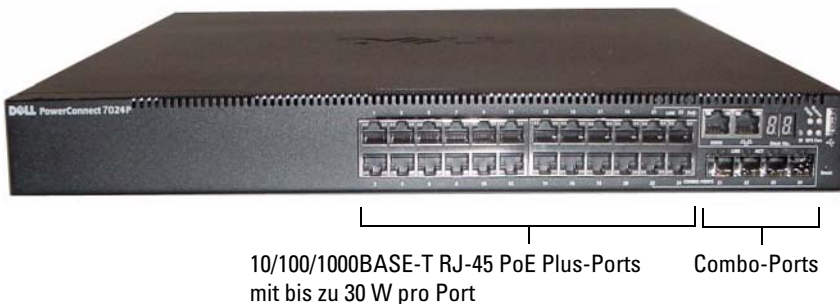
Abbildung 1-2. PowerConnect 7024P mit 24 10/100/1000BASE-T PoE Plus-Ports
