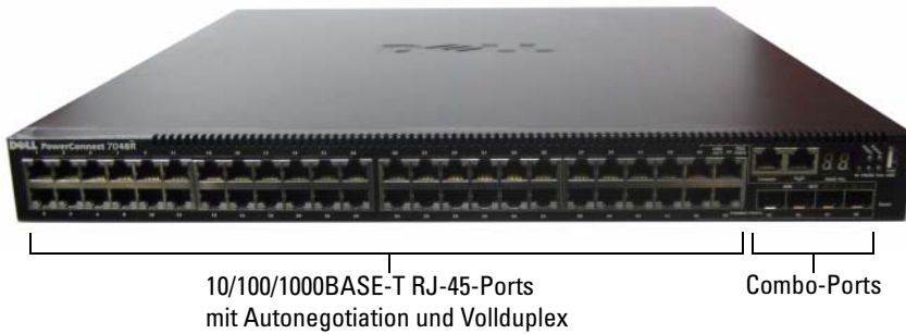
Abbildung 1-6. PowerConnect 7048R mit 48 10/100/1000BASE-T-Ports
