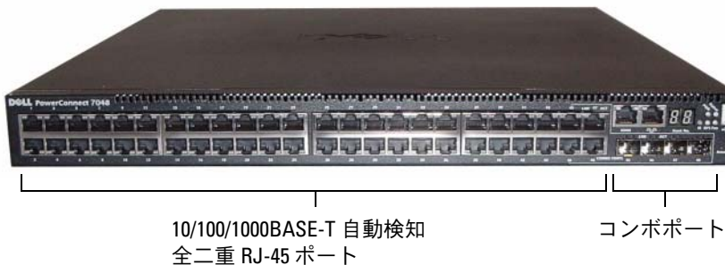
図 1-4. 10/100/1000BASE-T ポートを 48 個備えた PowerConnect 7048
