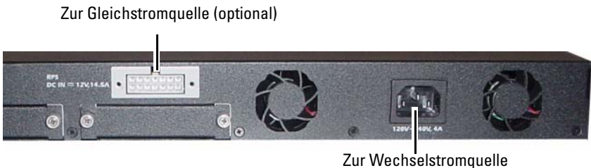
Abbildung 1-15. Wechselstrom- und Gleichstromversorgung zum Switch
